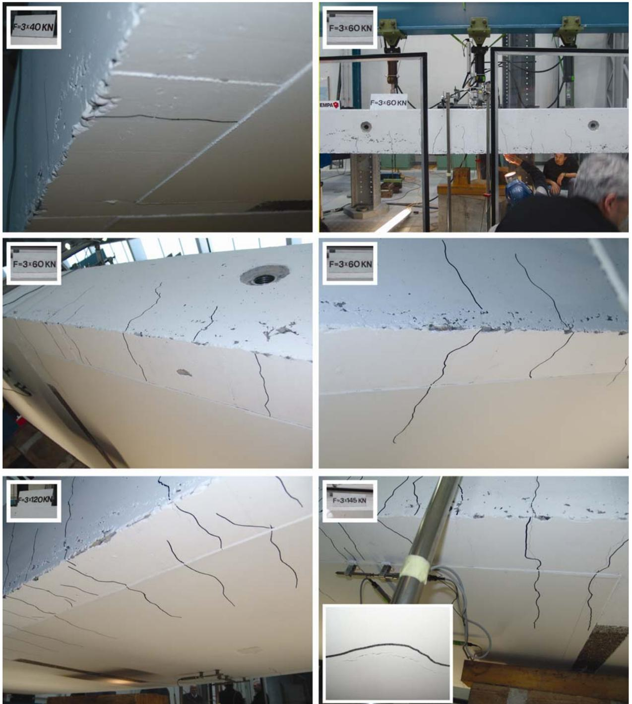
Bild 12: Entwicklung des Rissbildes während des Belastungsversuches auf maximale Durchbiegung.
