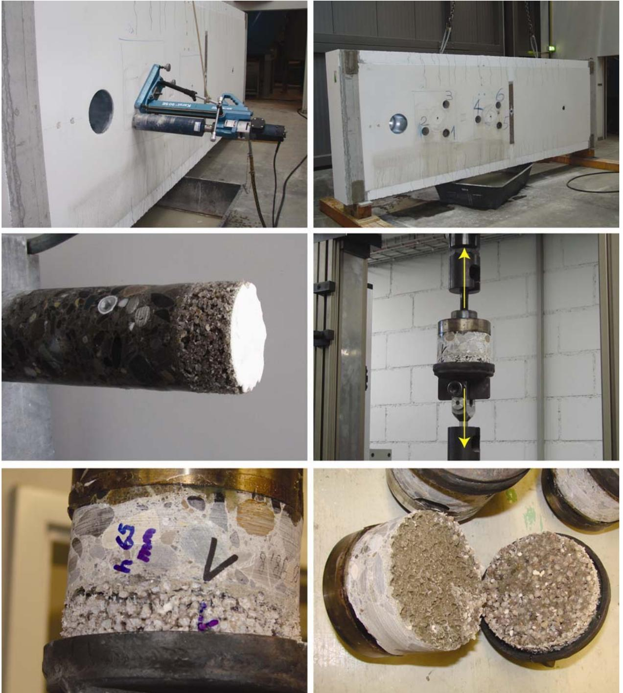
Bild 13: Oben links: Entnahme eines Bohrzylinders.
