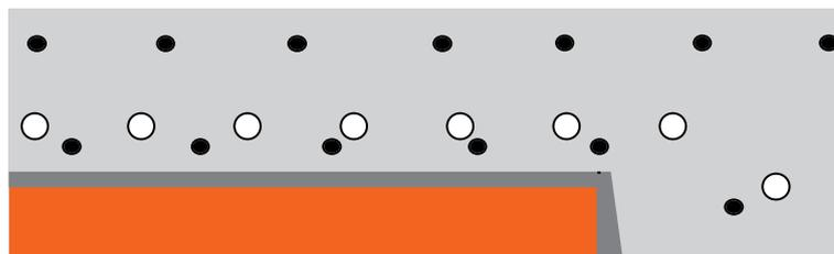
*tabsilent*® wird als Quarz-Absorberkörper von 5 cm Stärke direkt vor Ort in jeder gewünschten Form auf die Betonschalung aufgegossen.
